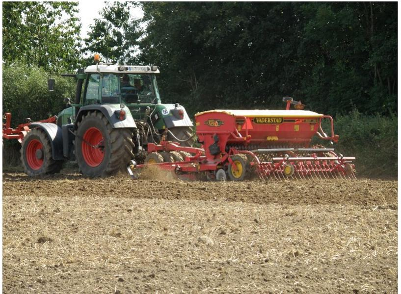
Bei **pneumatischen Systemen** ist der Säschlitz auf die Korngröße abzustimmen, um Quetschungen durch eine zu enge Einstellung zu vermeiden.
